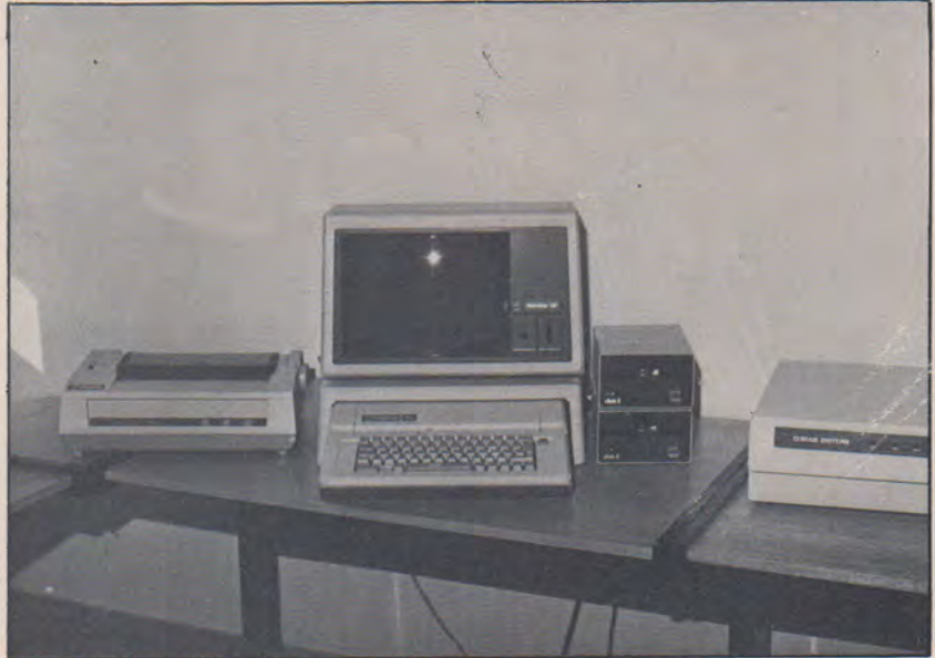
Ο IIe σε παράταξη. Monitor III, πληκτρολόγιο, δύο συστήματα δισκέτας, σκληρός δίσκος κι εκτυπωτής. Ότι χρειάζεται μια συνηθισμένη επιχείρηση.
